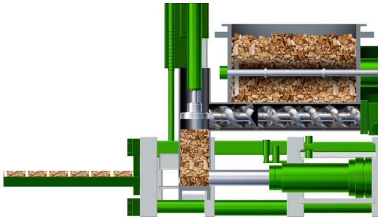
Figura 37. Maquinaria de presión de material aglomerado para la creación de cubos de madera. (Systems, 2016)
