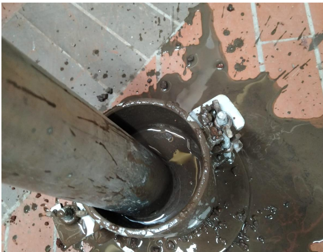
Figura 12 Ensayo de Proctor a más de 20% de agua.
