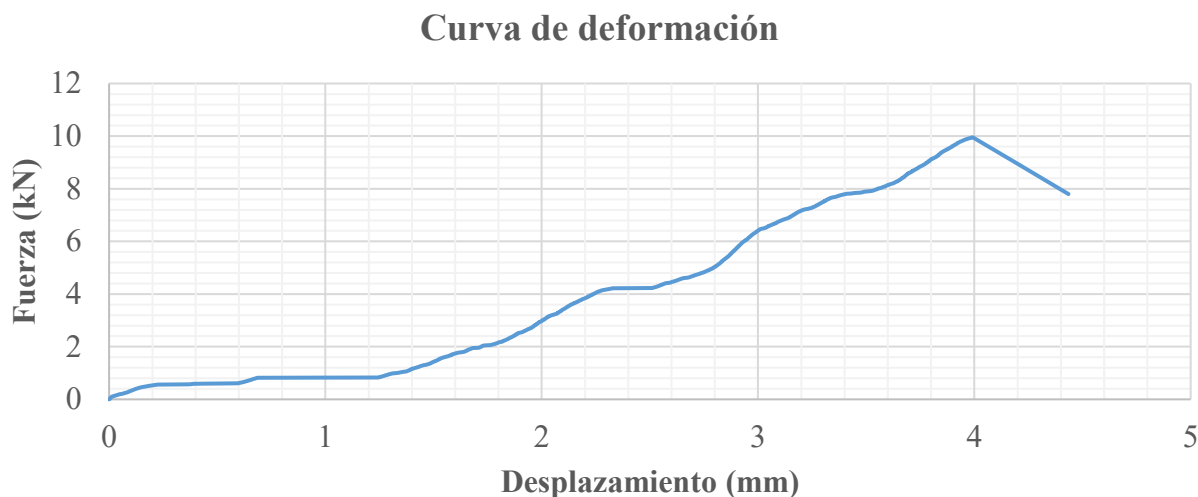
Figura 22 Curva de deformación a 15% de cemento-2
