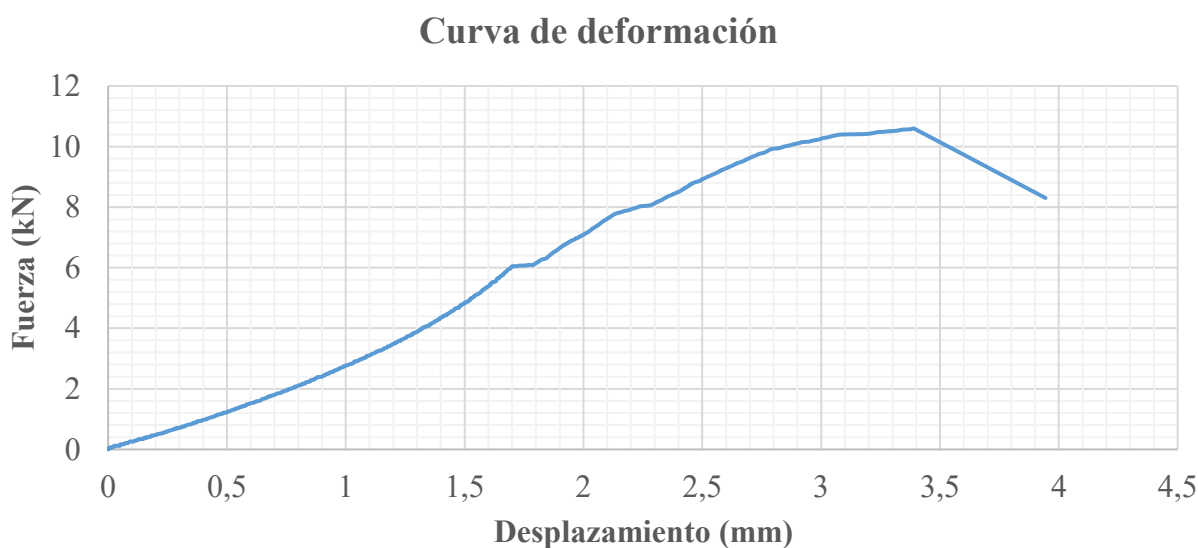
Figura 21 Curva de deformación a 15% de cemento-1
