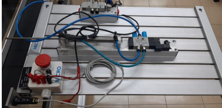
Imagen 12. Sistema electroneumático de compuerta
