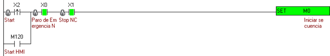
Imagen 43. Secuencia de programación Segundo Proceso IV
