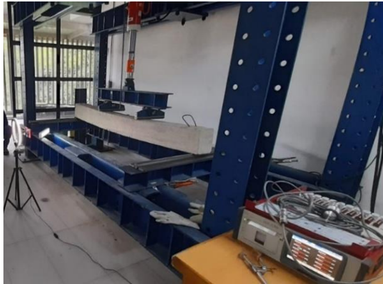
Figura 21. Ensayo de calibración del marco de carga.
