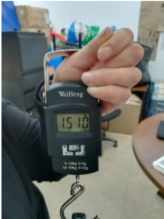
Figura 6: Reconocimiento de la báscula de gancho(Dinamómetro)
