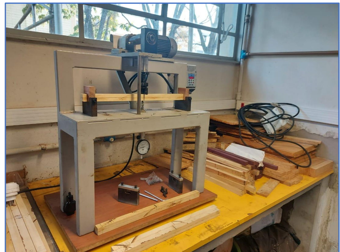
Medición de resistencia a la deformación y recuperación de la madera
