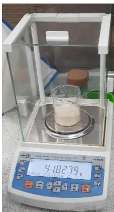
Figura 2. Balanza analítica para pesar la cantidad requerida en la preparación de agar
