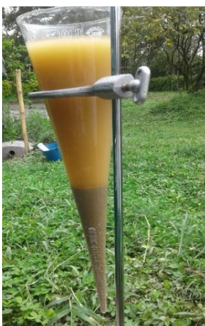
Figura 10. Muestra el Cono Imhoff durante la medición de sólidos sedimentables en la entrada del sistema de tratamiento. Por: Cortés & Rodríguez, 2017.
