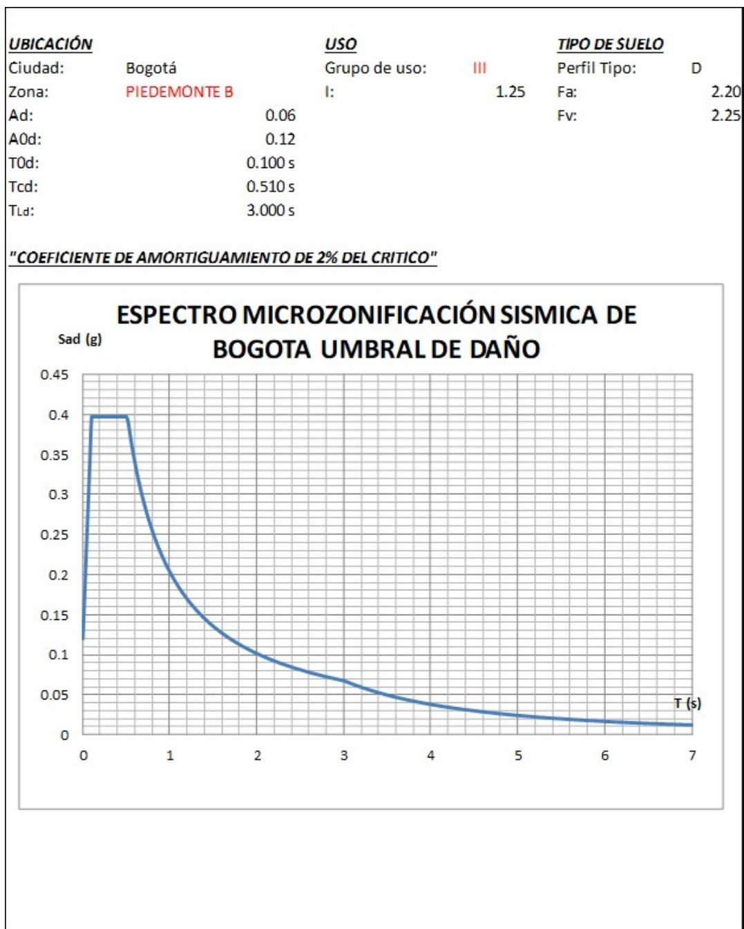
Figura 45: Espectro de umbral de daño. Adaptado de A.2.6- NSR-10
