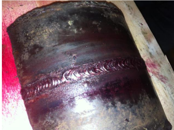
Ilustración 32: Remoción del exceso del penetrante
