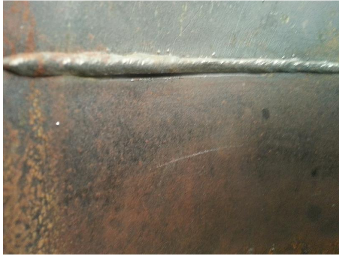
Ilustración 26: Discontinuidad de socavado interno inducido en la probeta
