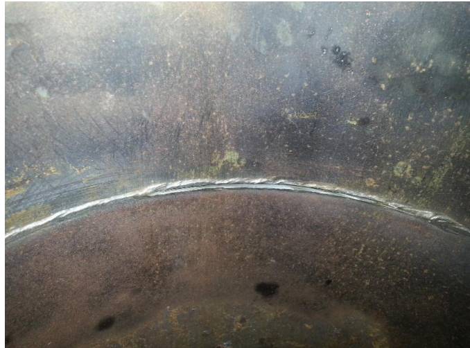
Ilustración 24 : Discontinuidad de falta de penetración inducida en la probeta.
