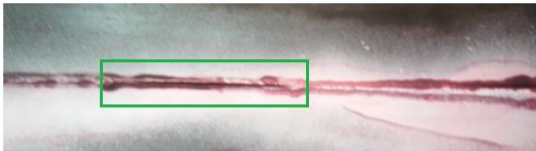
Ilustración 35: Aplicación de revelador en la raíz (Falta de penetración)
