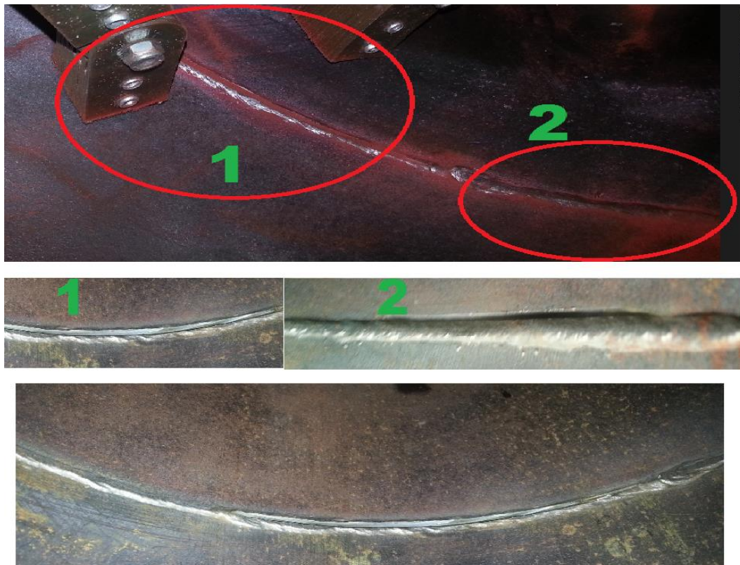
Ilustración 40: Falta de penetración (1) y sovacado interno (2) por END de Partículas Magnéticas
