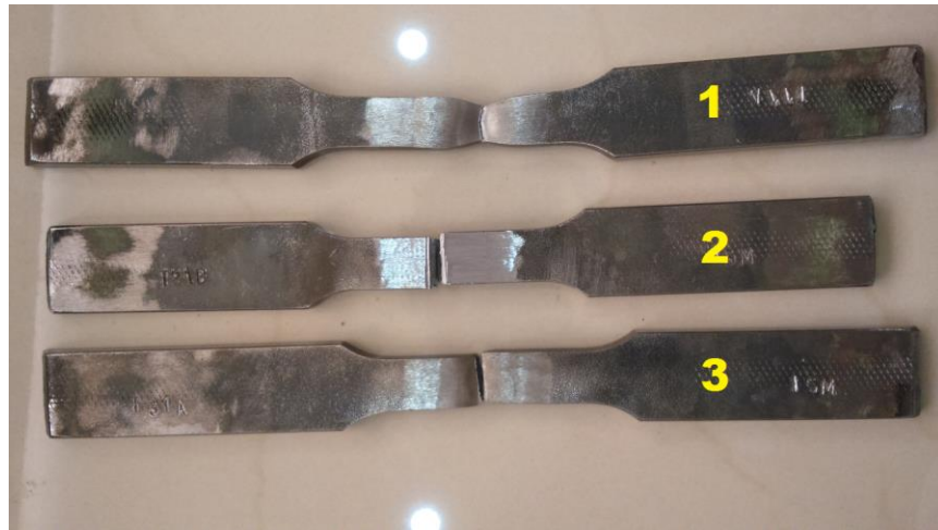
Ilustración 59: Probetas de ensayo a tracción finalizado. 1) Probeta sin discontinuidad, 2) Probeta con Fala de penetración, 3) Probeta con socavado interno.
