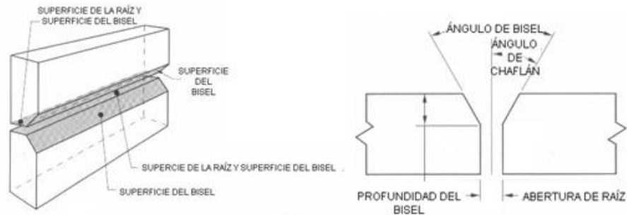
Ilustración 4: Características de Junta a tope
