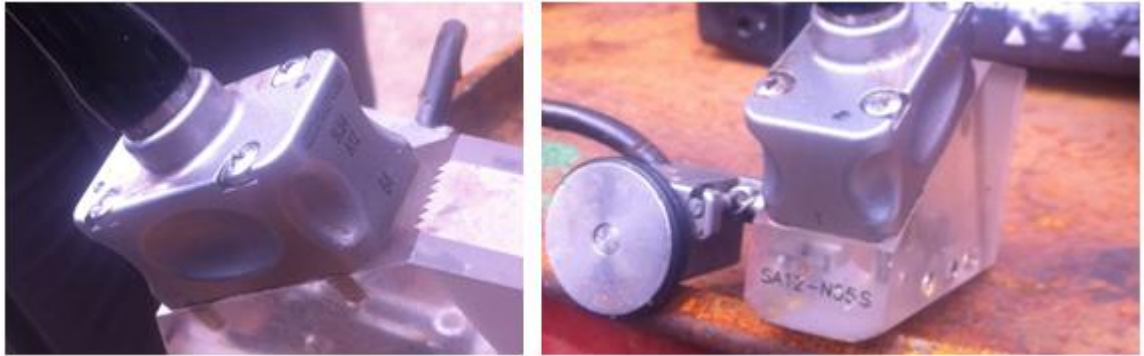
Ilustración 42: Palpador 5L64 A12 (Izquierda), Zapata SA12-N555 (Derecha)
