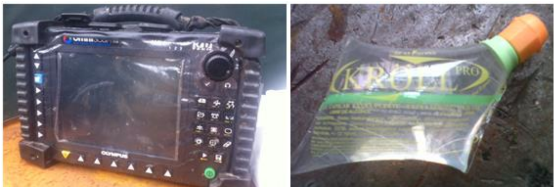
Ilustración 41: Equipo Olympus OmniScan (Izquierda), Acoplante (Derecha)
