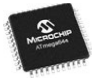
Figura 1. Microcontrolador ATmega644. Fuente: (Teslabem, 2018)
