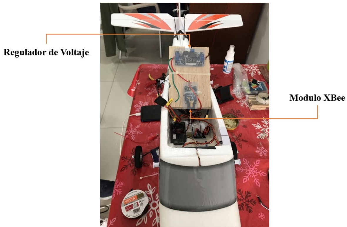
Figura 54. Sistema acomodado dentro del Aeromodelo Parte de Abajo. Fuente: Autor
