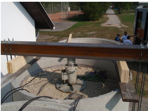
Figura 3, Placa de carga con elementos portantes
