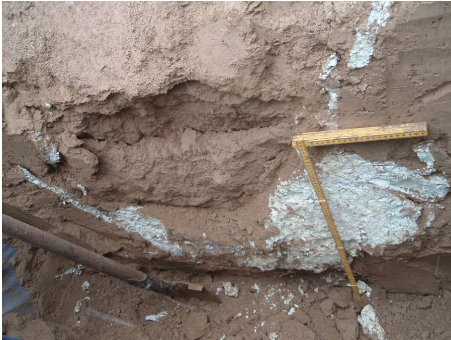
Figura 18, expansión de la resina en el área circundante el punto de inyección
