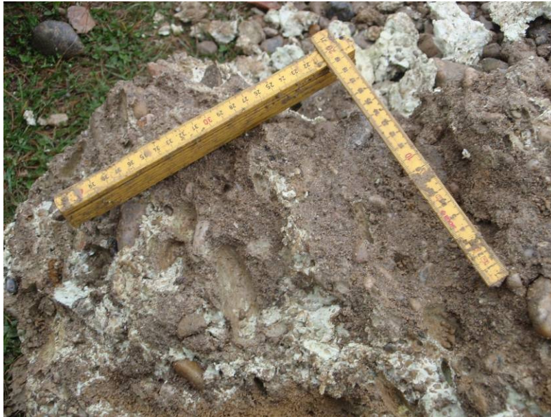
Figura 7, mezcla de grava y resina Uretek Geoplus®
