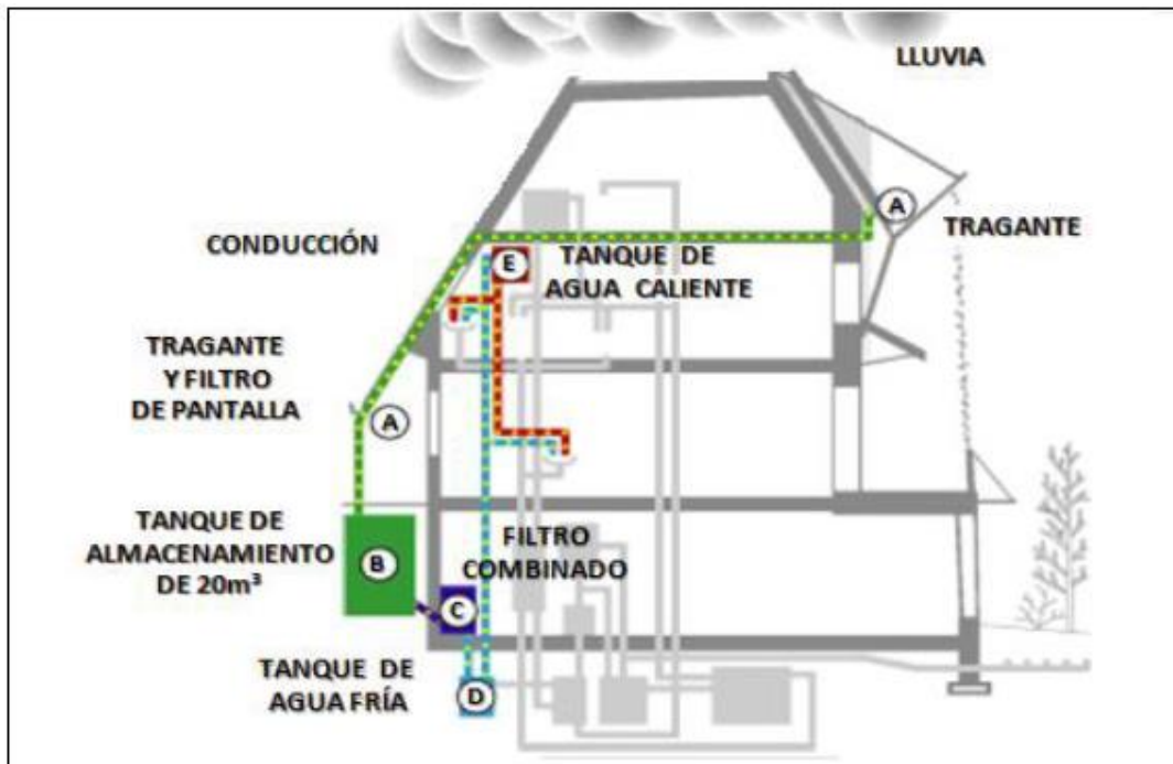
Figura 20: Esquema de funcionamiento del sistema de aprovechamiento de agua lluvia llamado “Healty House” en Toronto, Canadá.
