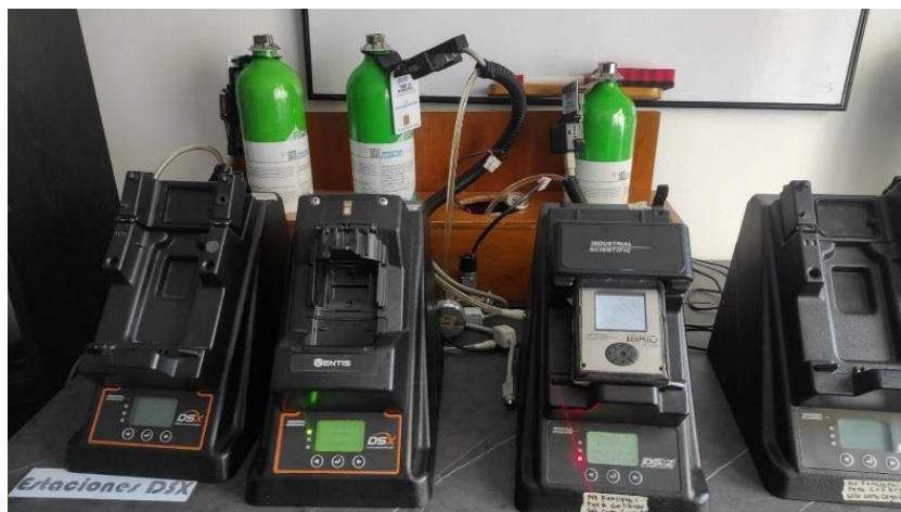
Figura 17. Estaciones de calibración para detectores portátiles.
