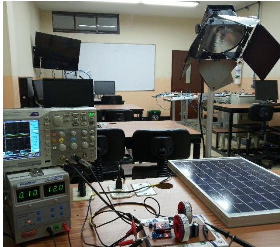
Figura 70. Pruebas con paneles solares y el Convertidor Boost Cuadrático.
