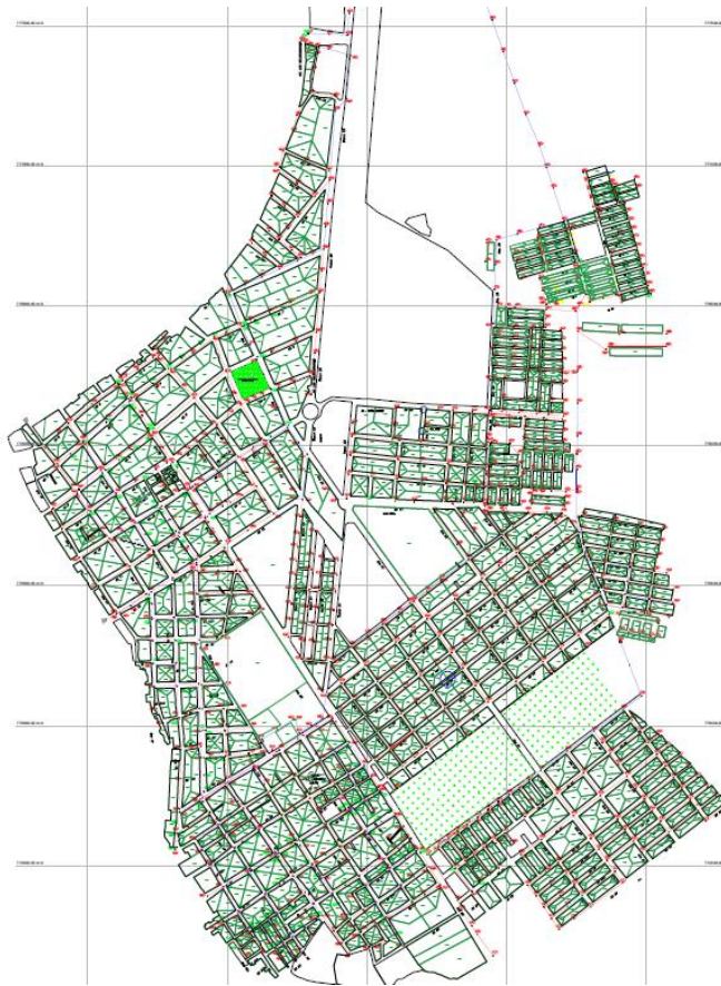
Figura 25. Red alcantarillado sanitario
