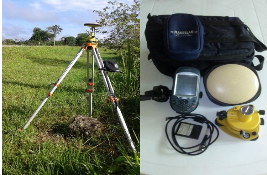
Figura 7 GPS Diferencial base MT-T-62 Fuente: Levantamiento topográfico
