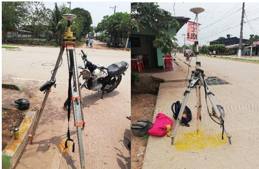
Figura 8 GPS poligonación Cra. 19 Barrio el Modelo Fuente: Levantamiento topográfico
