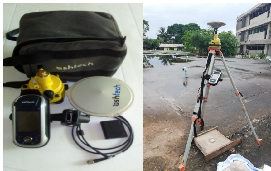
Figura 6 GPS Base EMPOAGUAS E.S.P Fuente: Levantamiento topográfico
