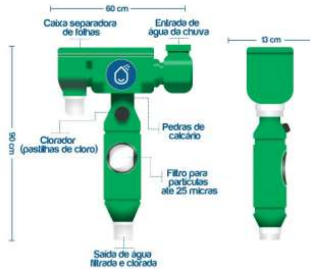
Figura 28 funcionamiento de cada parte del filtro de polietileno – Tomado de EcoInventos green technology
