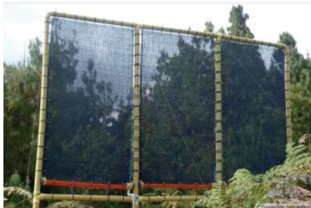
Figura 10 Mallas captadora de agua por medio de neblina
