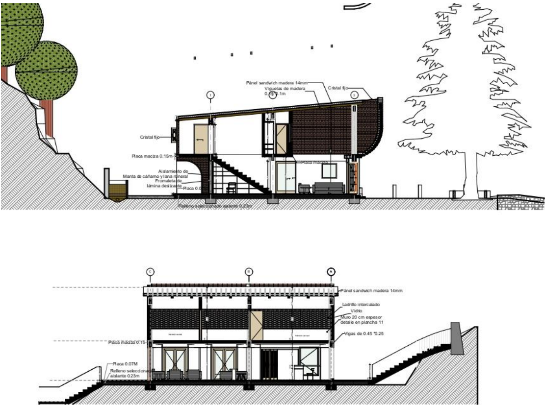
Figura 17: Corte longitudinal y transversal escala 1:250
