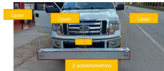
Grafica Adaptación internas de vehículo para la recolección de datos del perfilómetro laser
