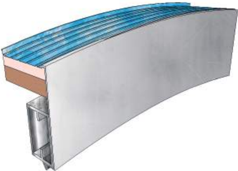
Figura 148- detalle constructivo 3D Fuente: Gutiérrez Osorno J. 2021
