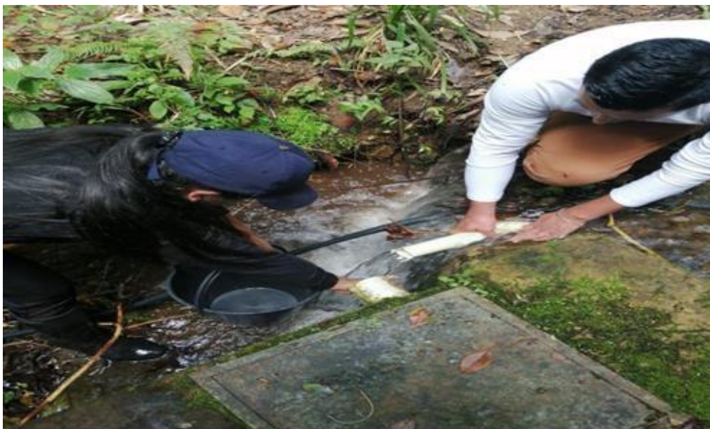
Imagen 2. Medición de caudal.
