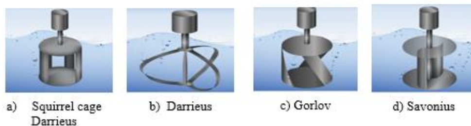
Fig. 4. Diseño basado en Darrieus (a, b y c) y diseño en Savonius (d): tomado de [9]
