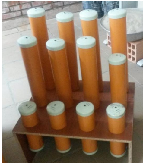
Ilustración 11. Montaje de las columnas de suelo
