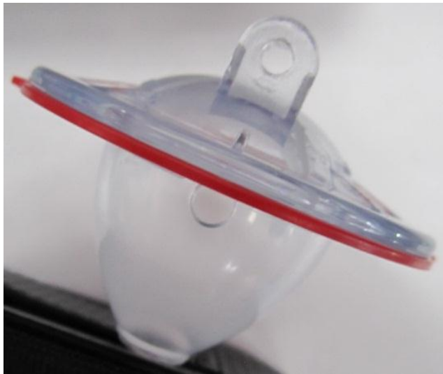
Figura 10. Etapa inicial en el ensamble de la válvula flapper (Fuente: Autor)
