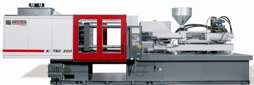
Figura 2. Una máquina de moldeo por inyección capacidad de 200 ton (Fuente: Cortesía de Cincinnatti Milacron)
