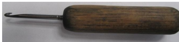
Figura 11. Herramienta utilizada en ensamble de correa flapper (Fuente: Autor)
