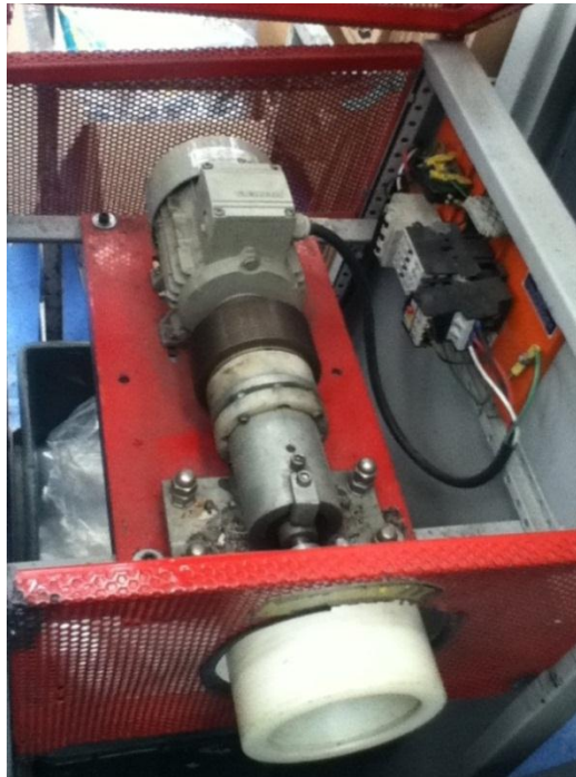
Figura 26. Equipo para roscar válvulas Atlas y Atlantis (Fuente: Autor)
