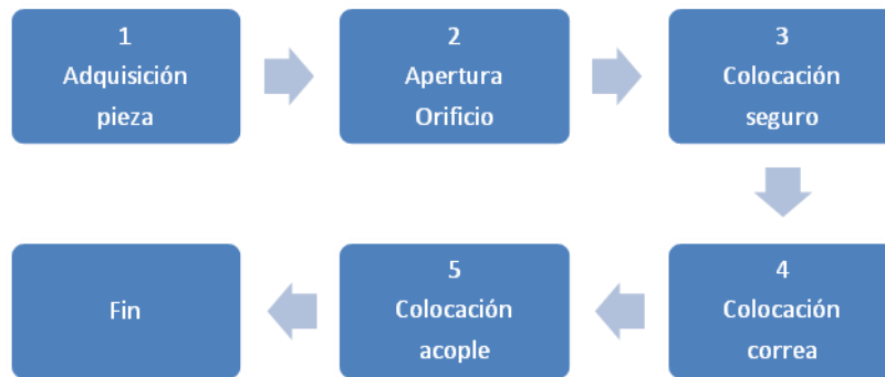
Figura 22. Diagrama de etapas proceso válvula flapper (Fuente: Autor)
