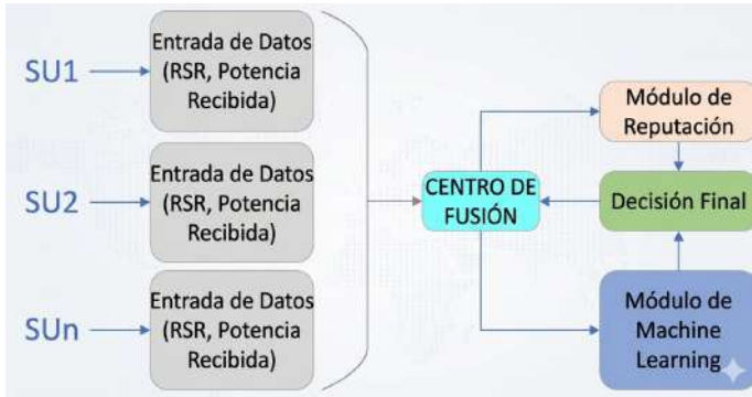
Figura 1. Modelo general de detección para el proceso de entrenamiento (fuente: propia).
