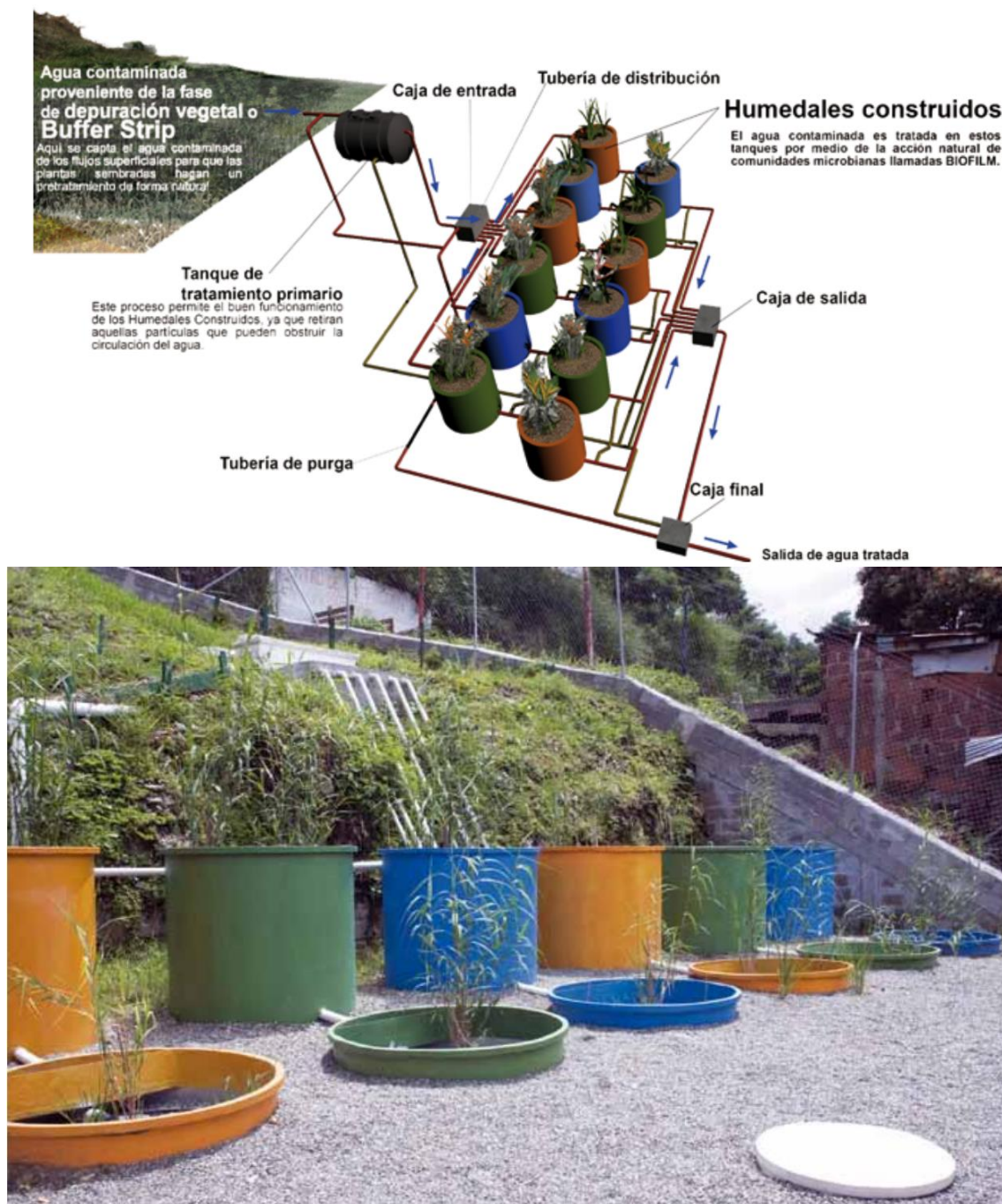
Figura 68. Planta piloto para el tratamiento de lixiviados Moravia, humedal de flujo vertical - Ejecución
