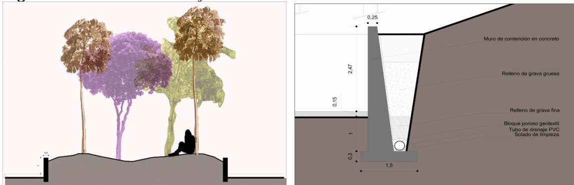
Figura 115. Detalle de muros y muretes
