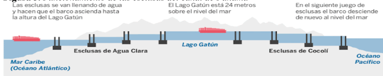
Figura 3. Funcionamiento de las esclusas del canal de Panamá
