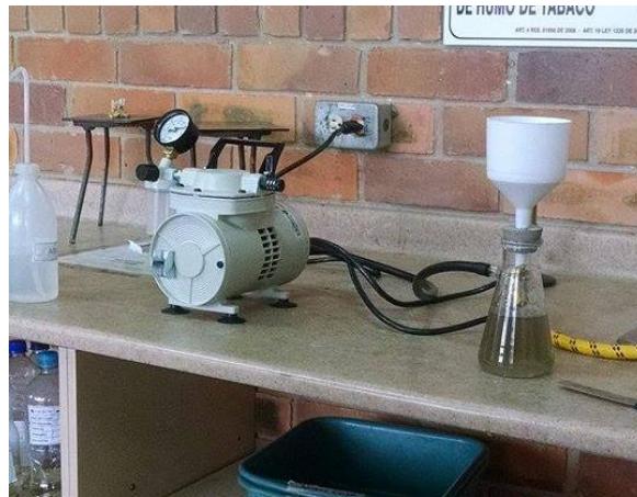
Foto 31. Equipo de filtración. Fuente: Los Autores
