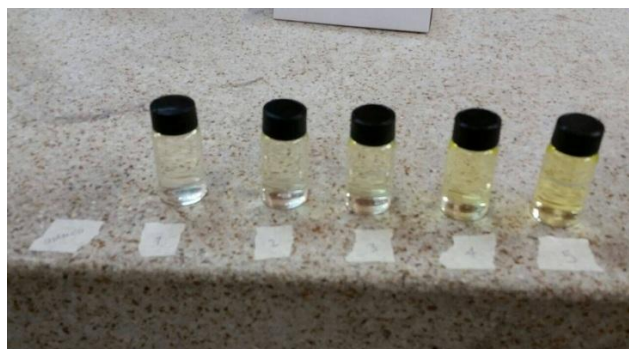
Foto 34. Celdas para la determinación de curva de calibración y concentración de fosfatos. Fuente: Los Autores
