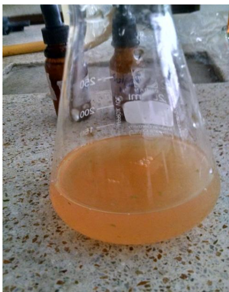
Foto 14. Muestra de agua con Sulfato manganoso y Álcali-Yoduro. Fuente: Los autores
