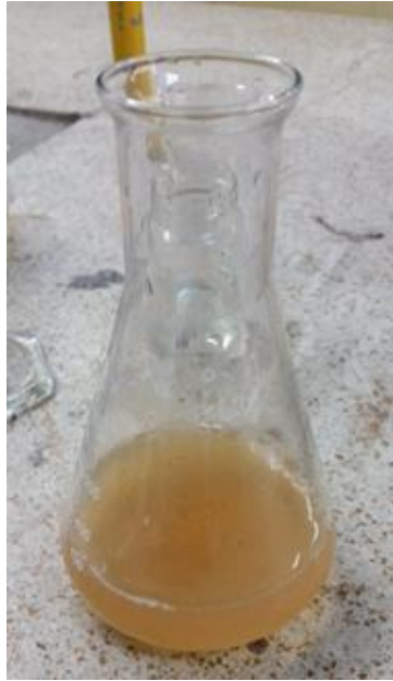
Foto 22. Muestra de agua con Sulfato manganoso y Alkali-Yoduro. Fuente: Los Autores
