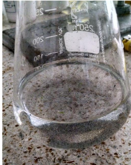
Foto 17. Muestra de agua después de la titulación con tiosulfato. Fuente: Los autores.
