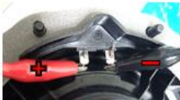
Imagen 3. Conexión directa a la bocina
