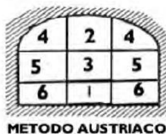
Figura 6.4. Esquema método constructivo Austriaco.
