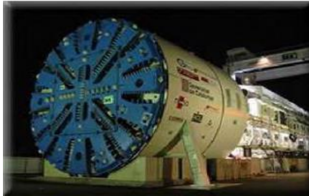
Figura 6.5. Vista perspectiva de una moderna tuneladora que se utilizará para la construcción de la futura línea 9 del Metro en Barcelona.
