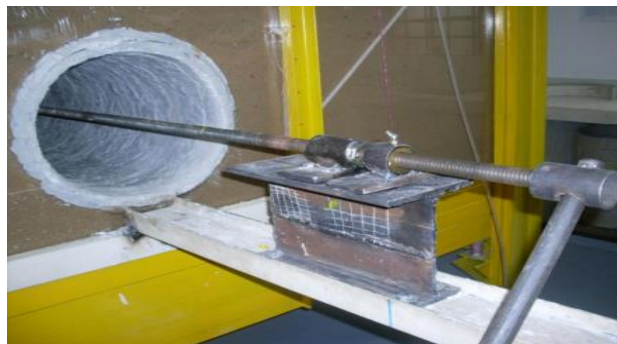
Figura 6.7. Modelo físico sistema mecánico de perforación avance de tuneladoras TBM-EPB en suelos blandos
