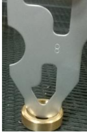
Figura 41. Medición radio del casquete esférico con galga
