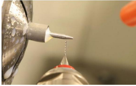
Figura 16. Cono de 14° para reloj
