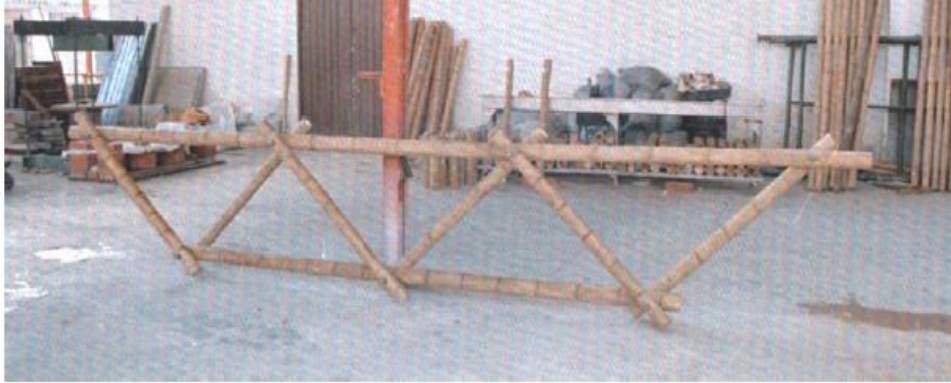
Foto No. 4. Armadura con torsión en los cordones superior e inferior por excentricidad en la unión de las diagonales. (tomado de la referencia No 2)
