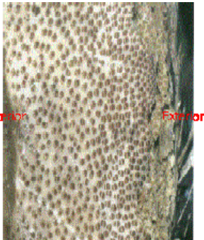
Foto No.2. Pared de guadua (tomado de la referencia No 1)
