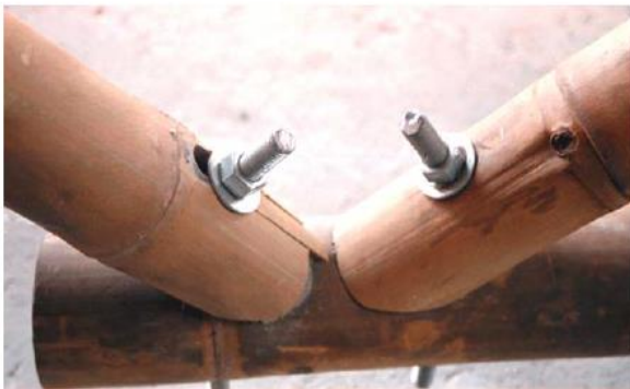
Foto No10. Falla por corte paralelo a las fibras. (tomado de la referencia No2 )
