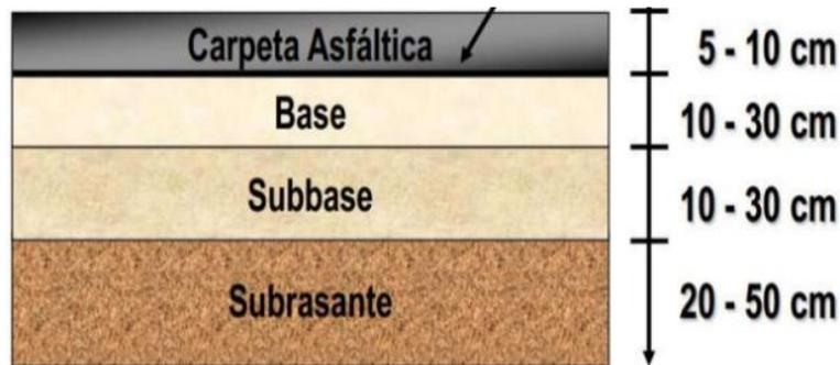
Figura 6.6. Perfil de una estructura de pavimento flexible
