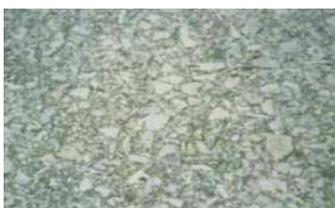
**DESCRIPCIÓN.** Este daño se evidencia por la presencia de agregados con caras planas en la superficie o por la ausencia de agregados angulares, en ambos casos se puede llegar a afectar la resistencia al deslizamiento.
