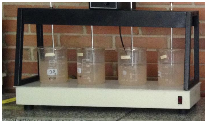
Figura 9: Muestras preparadas para el Ensayo de Jarras
