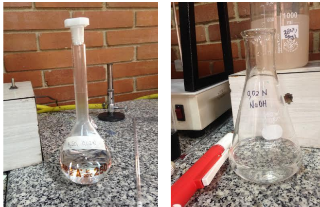
Figura 15: Ácido Sulfúrico e Hidróxido de Sódio al 0.02N.
