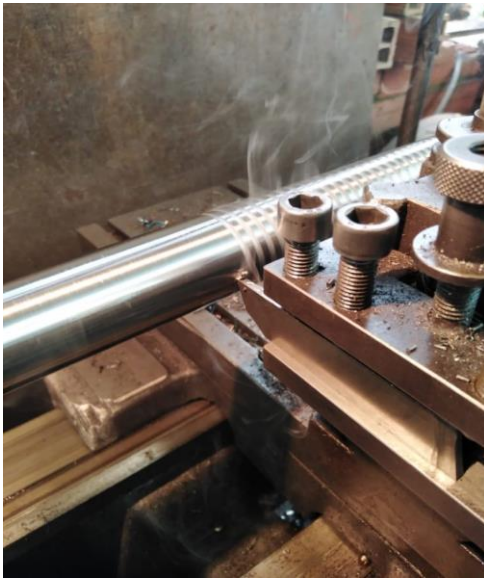
Figura 40. Construcción de pistón
