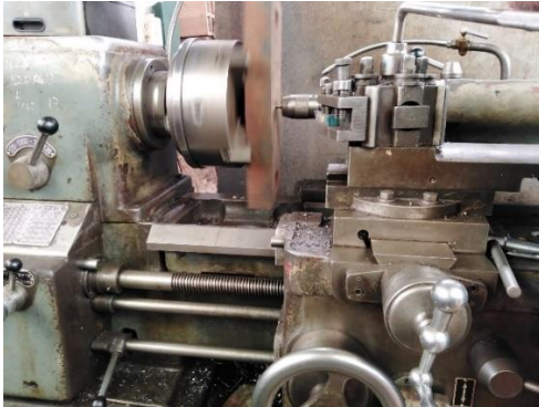
Figura 18. Maquinado de placa
