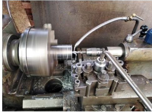
Figura 15. Maquinado tuercas soportes
