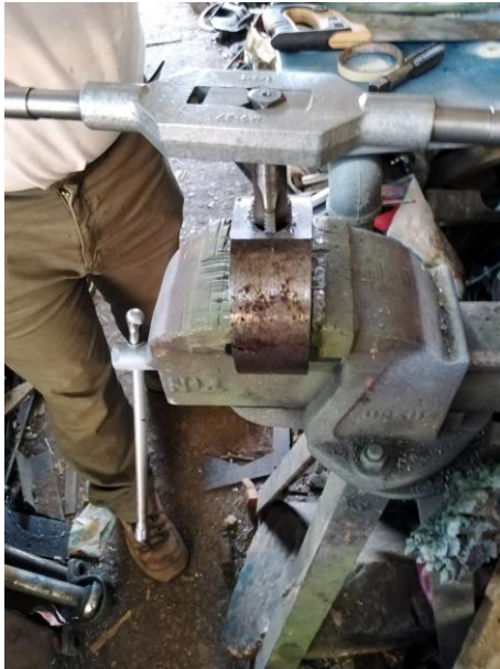
Figura 49. Construcción de muelas
