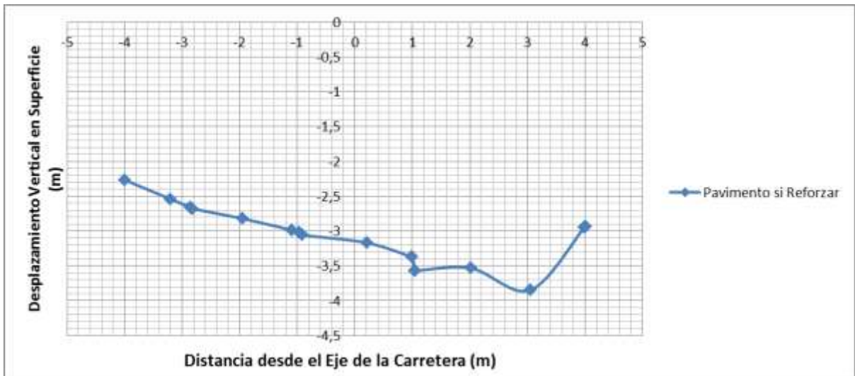
Figura 6,26. Deformaciones superficiales debidas al peso de un camión (Autor)
