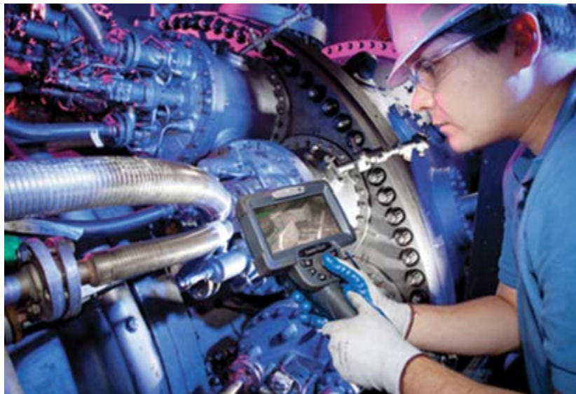
Figura 26. Inspecciones boroscópicas. Ensayos no destructivos.
